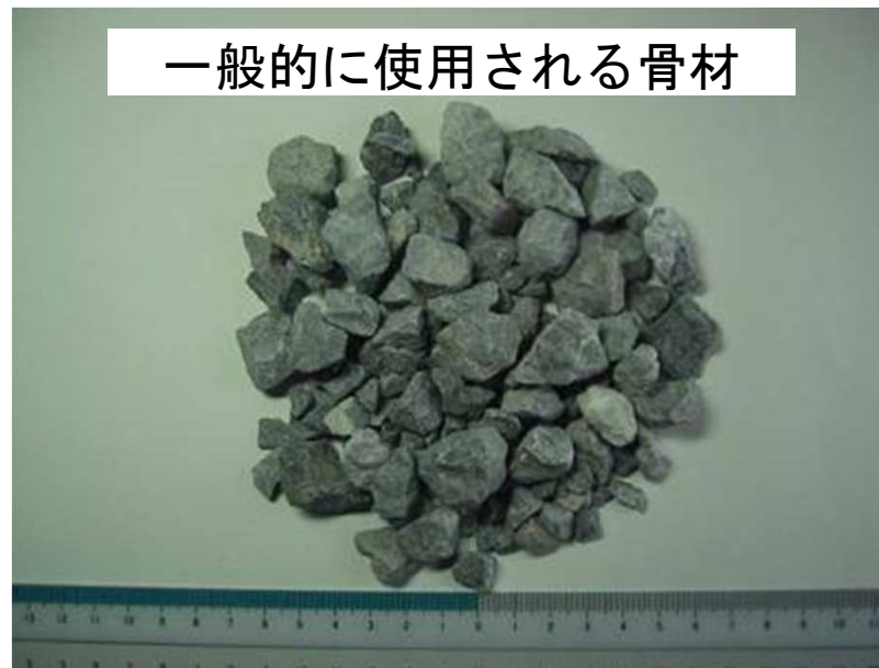
生コン用骨材（碎石 最大20mm）
