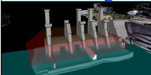
P5を倒壊発破で倒し撤去
