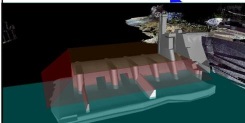
P2を倒壊発破で倒し撤去する
