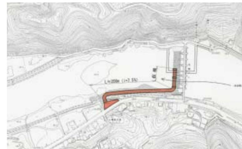
図3-9 右岸側撤去時の進入路配置（左岸下流）
