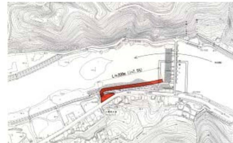
図3-8 左岸側撤去時の進入路配置
