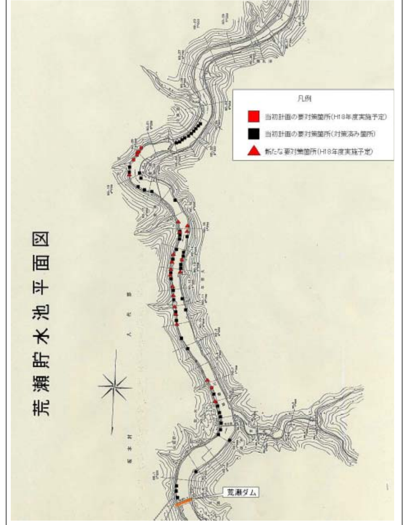
【擁壁(護岸)補修施工箇所】
