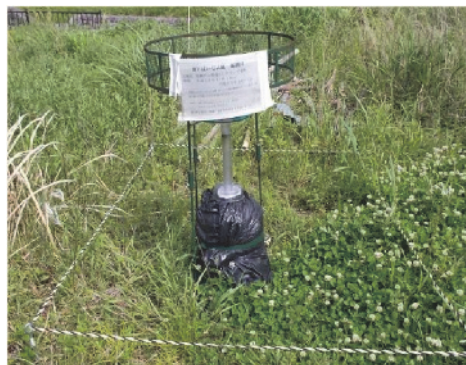
写真- 2.7 粉塵の測定状況
