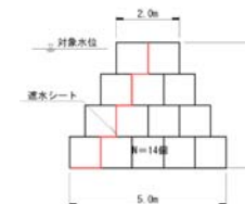
図-1.1.8 大型土のう標準断面図
