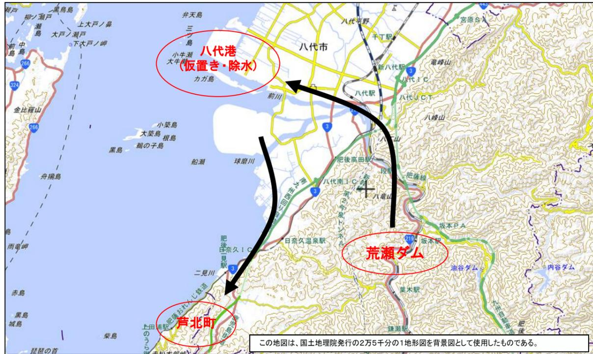
「荒瀬ダム撤去方針」に基づき、ダム貯水池に堆砂した砂・礫は概ね10万m<sup>3</sup>を除去、泥土（シルト）は、ダム撤去までに全量除去することとしている。
