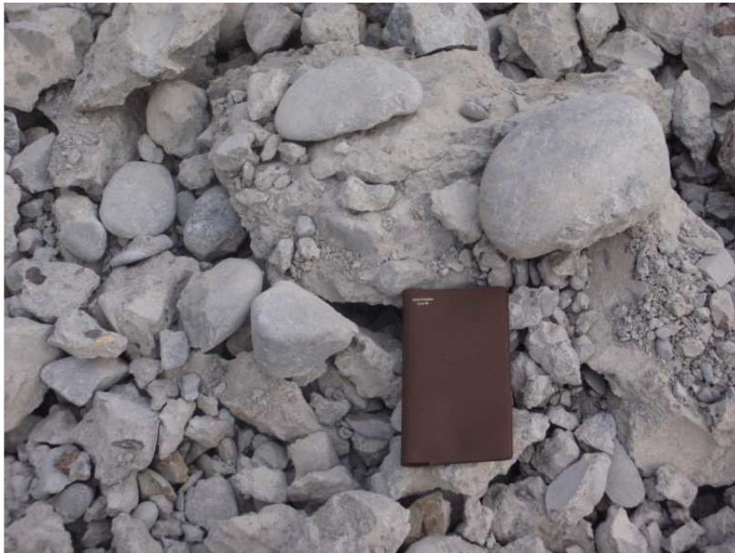
荒瀬ダムで使用されていた骨材 （玉石 150mm内外）
