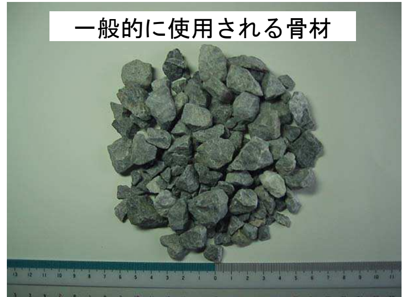
生コン用骨材（碎石 最大20mm）
