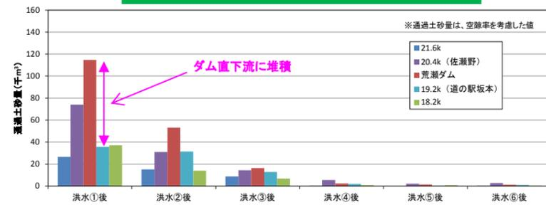
洪水毎の通過土砂量（粒径別）
