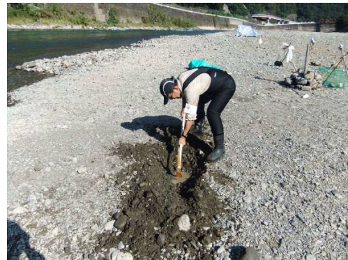
中州を70cm掘り下げ、濁水状態の水の溶存酸素濃度を計測
