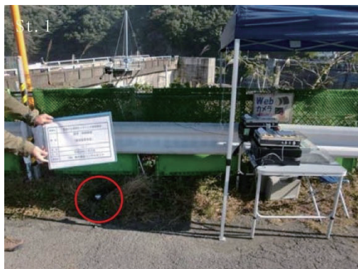
写真 2.7.3 振動調査の実施状況
