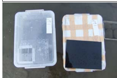
【明暗ビン法現地実験】
